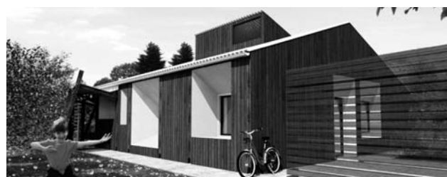
Rys. 2. Widok domu – wnęki okienne pełniące rolę osłon przeciwsłonecznych
