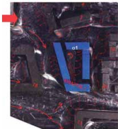
Il. 11. Przeptyw powietrza przez kwartał 1 w wariancie 1 przy wietrze od zachodu (oznaczenie o1 określa położenie wprowadzonego otwarcia), fotografia z badań tunelowych metodą olejową, fot. A.Mutkowska
