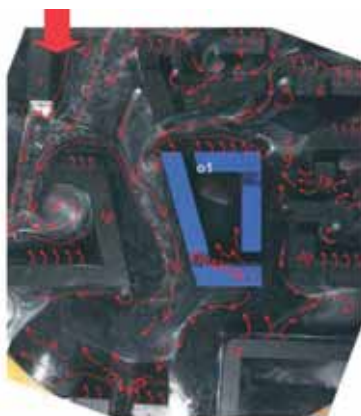
Il. 8. Przepływ powietrza przez kwartał 1 w wariantie 1 przy wietrze od północy (oznaczenie o1 określa położenie wprowadzonego otwarcia), fotografia z badań tunelowych metodą olejową, fot. A. Mutkowska
