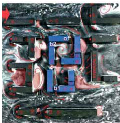
Il. 18. Przepływ powietrza przez kwartał 2 w wariantie 2 przy wietrze od zachodu (oznaczenie o1 określa położenie wprowadzonego otwarcia, b1, b2-bramy), fotografia z badań tunelowych metodą olejową, fot. M. Groblewska
