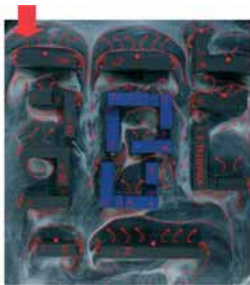
Il. 13. Przepływ powietrza przez kwartał 2 w podstawowej wersji projektu przy wietrze od północy, fotografia z badań tunelowych metodą olejową, fot. M. Groblewska
