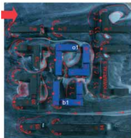
Il. 17. Przepływ powietrza przez kwartał 2 w wariantie 1 przy wietrze od zachodu (oznaczenie o1 określa położenie wprowadzonego otwarcia, b1-bramy), fotografia z badań tunelowych metodą olejową, fot. M. Groblewska
