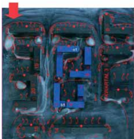
Il. 14. Przepływ powietrza przez kwartał 2 w wariantie 1 przy wietrze od północy (oznaczenie o1 określa położenie wprowadzonego otwarcia, b1-bramy), fotografia z badań tunelowych metodą olejową, fot. M. Groblewska.
