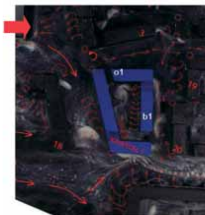
Il. 12. Przeptyw powietrza przez kwartał 1 w wariancie 2 przy wietrze od zachodu (oznaczenie o1 określa położenie wprowadzonego otwarcia, b1-bramy), fotografia z badań tunelowych metodą olejową, fot. A.Mutkowska
